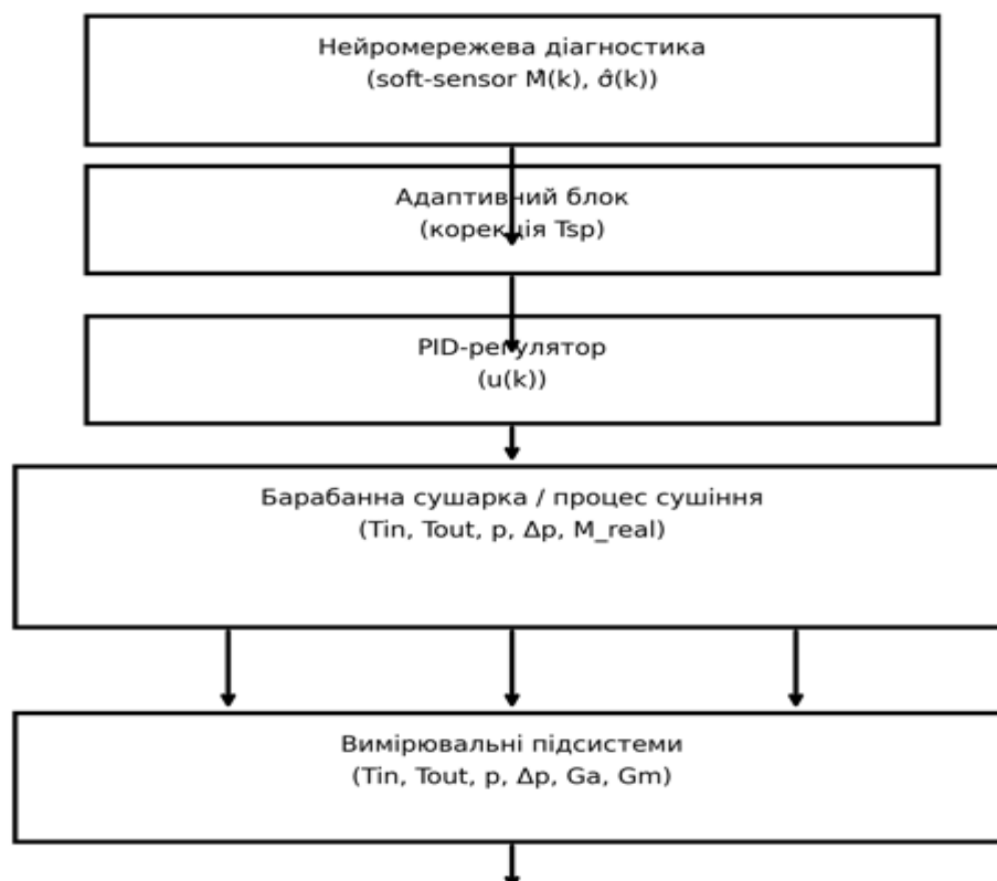
Рис. 1. Інтегрована систему керування, у якій нейромережевий soft-sensor та адаптивний модуль підсилюють роботу PID-регулятора, забезпечуючи точну й стійку автоматизацію процесу сушіння утфелю
